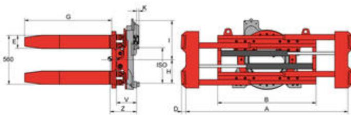
360° 旋转 无限位 - 带有两对可移动货叉组- 叉车需提供双附加油路
