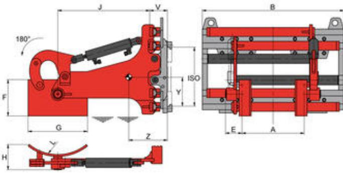
非侧移功能 - 带液压旋转式夹臂 180°向前 - 叉车需提供双附加油路
