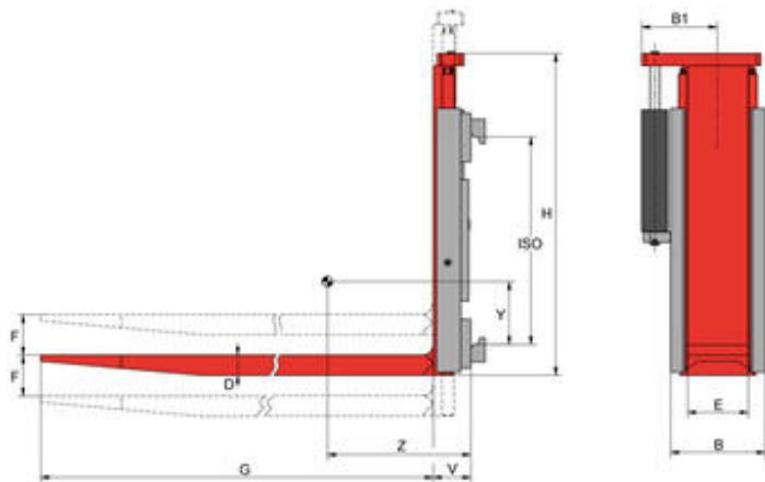
用于安装在ISO货叉架上 - 叉车须提供单附加油路, 高度可调货叉通常与挂装式货叉一起使用来进行补偿。
