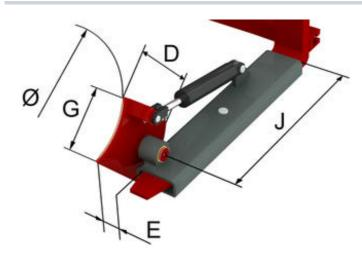
套装式夹臂 - 液压式旋转90°, 叉车须提供单附加油路
