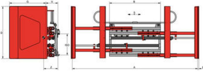
单独侧移 - 带橡胶衬垫 - 双臂固定 - 叉车需提供双附加油路
