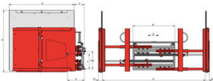
单独侧移 - 带橡胶衬垫 - 一条臂可摆动，一条臂固定 - 叉车需提供双附加油路
