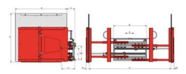
单独侧移 - 带橡胶衬垫 - 一条臂可摆动, 一条臂固定 - 叉车需提供双附加油路
