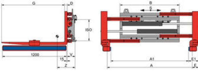
单独侧移 - 带套装式悬挂臂 - 主要用于搬运建筑材料 - 叉车需提供双附加油路, 叉夹 T411 带有悬挂式夹臂型号 (带有聚氨酯夹板) T102UVP
