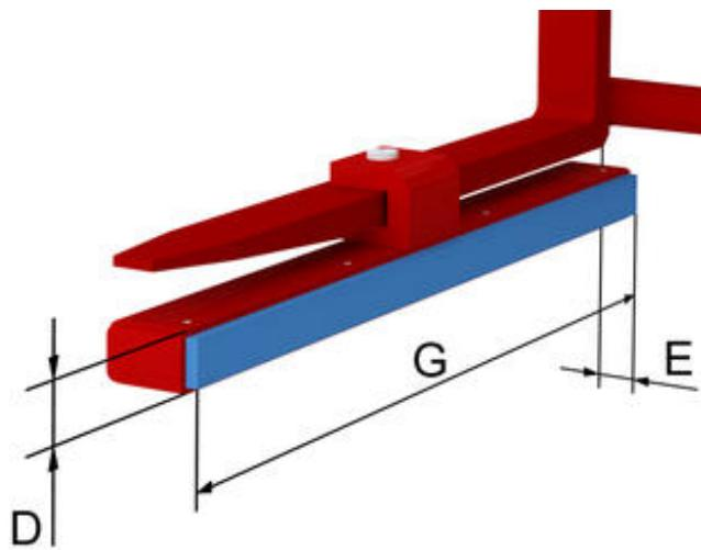
下吊式夹臂砖块夹带有聚氨酯夹板
