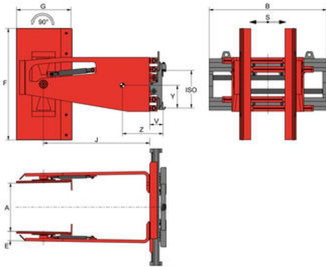
单独侧移 - 带橡胶衬垫 - 双臂可90°前倾 - 叉车需提供双附加油路 + 电磁阀
