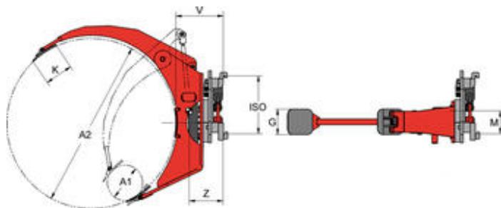
短臂固定 - 叉车须提供双附加油路, 该纸卷夹尤其适合较细的纸卷 (最小宽度150mm)
