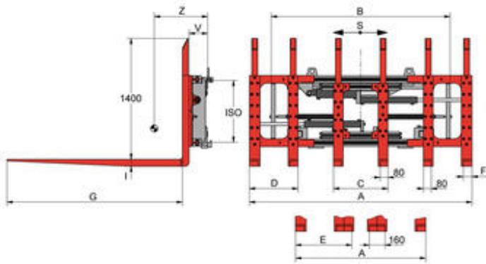
单独侧移 - 带螺栓固定式货叉, 托盘叉夹方向 800 x 1.200 mm 使用于4或6个托盘 - 叉车须提供双附加油路
