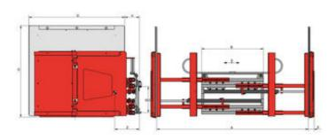
单独侧移 - 带橡胶衬垫 - 双臂可摆动 - 叉车需提供双附加油路
