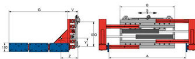
单独侧移 - 带机械液压型平衡柱塞及带聚胺酯条 - 叉车需提供双附加油路
