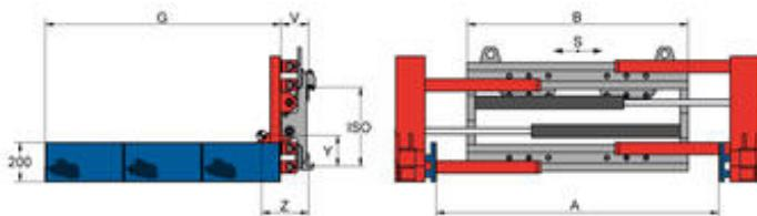
单独侧移 - 带机械液压型平衡柱塞 - 叉车需提供双附加油路
