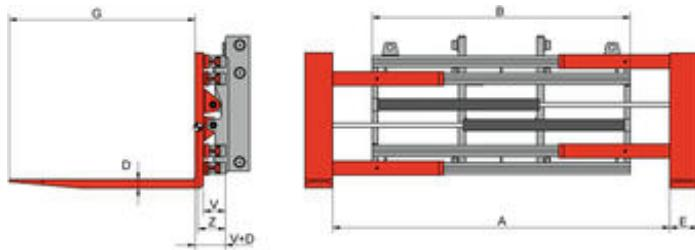
阀体式侧移 (侧移量取决于张臂范围) - 叉车需提供双附加油路
