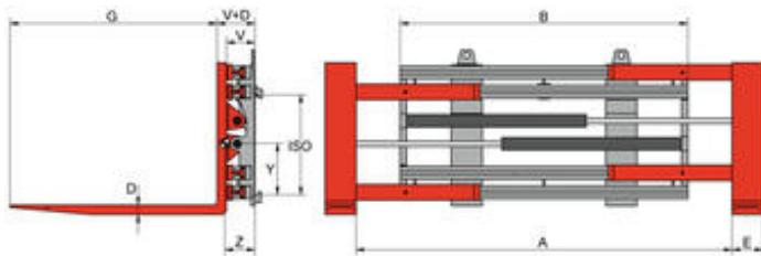
阀体式侧移（侧移量取决于张臂范围）- 叉车需提供双附加油路
