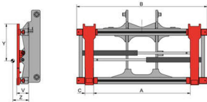
阀体式侧移（侧移量取决于张臂范围）- 属具不带货叉，用于带特殊挂装式快换系统的货叉 - 叉车须提供双附加油路
